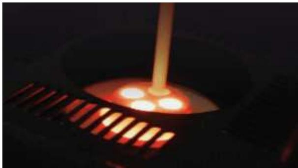
Les ingénieurs d'étalonnage comprennent que pour obtenir la meilleure précision, les capteurs de température doivent être plongés profondément dans un bain d'étalonnage ou un four et comparés à un thermomètre de référence.
